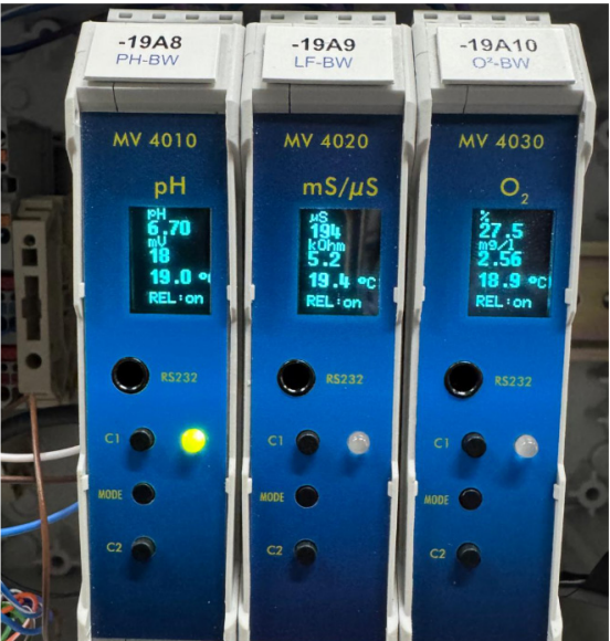
▲ Foto: het water kan worden gemeten: pH waarde, elektrisch geleidbaarheid en zuurstofgehalte.
